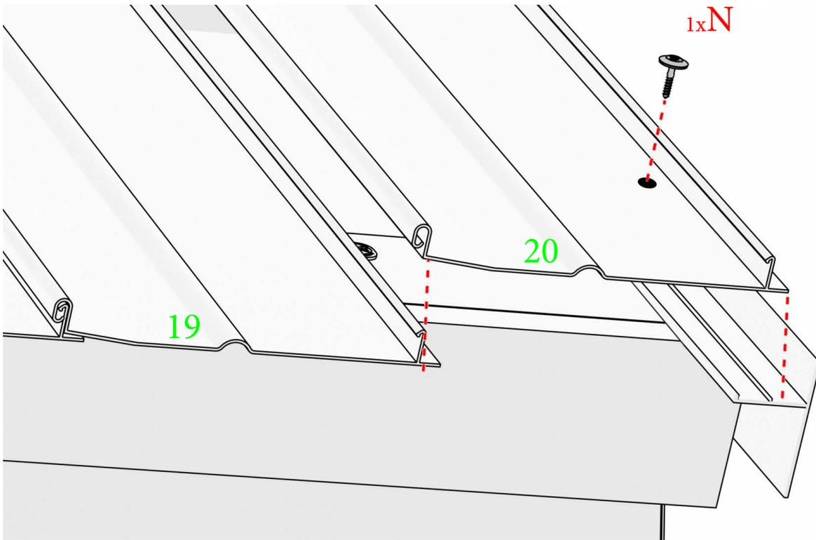
Letzte Bahn A einclipsen und erneut 4 mal durch vorgebohrtes 10er Loch mit Ortgang C in Kernprofil J-4970 schrauben.
