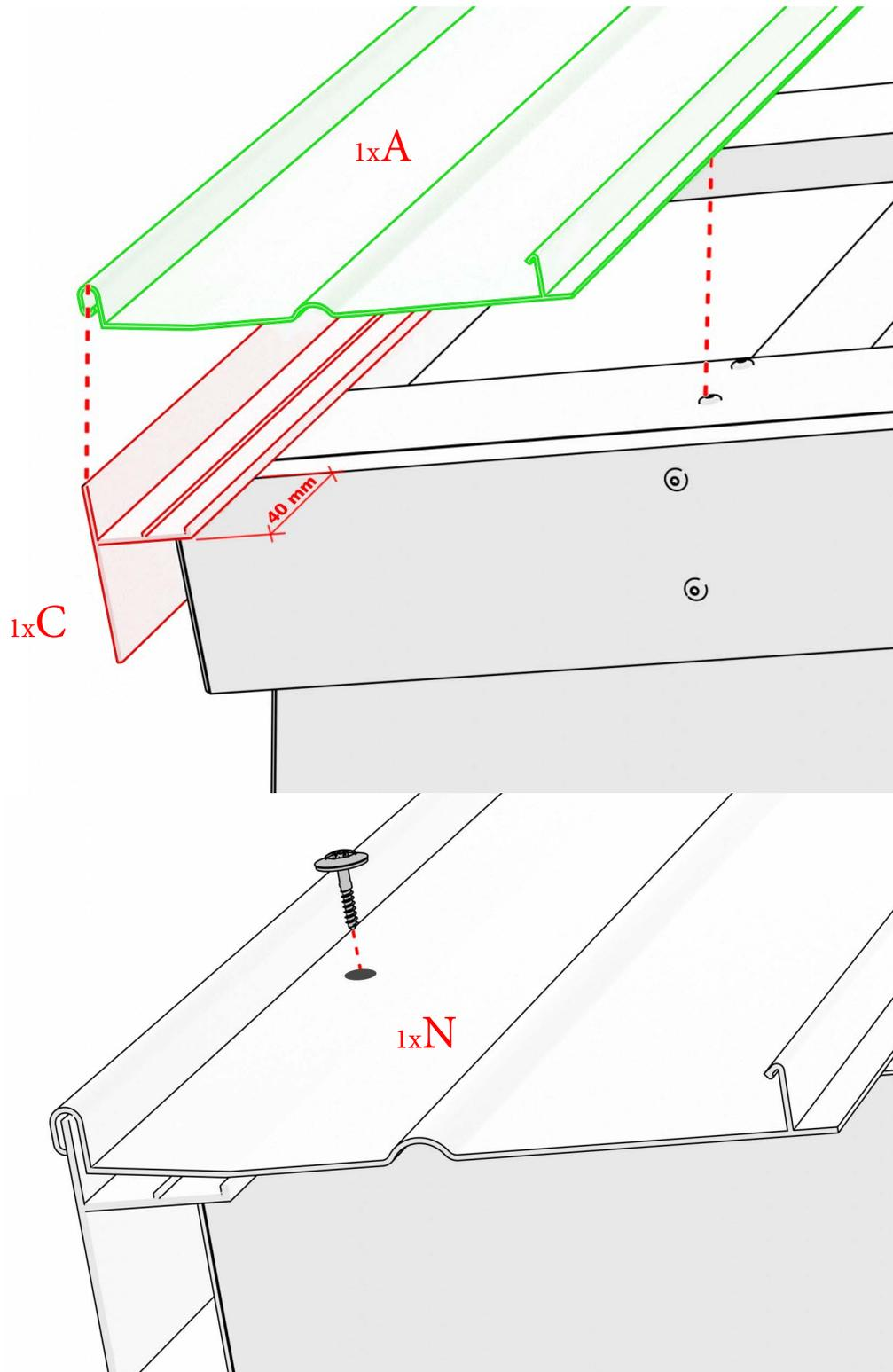
Mit 10er Bohrer Dachbahn A und Ortgang C vorbohren und 4 mal pro Dachbahn (1 mal mit jedem der vier Konterprofile E-5050 und Kern J-4970) verschrauben.
