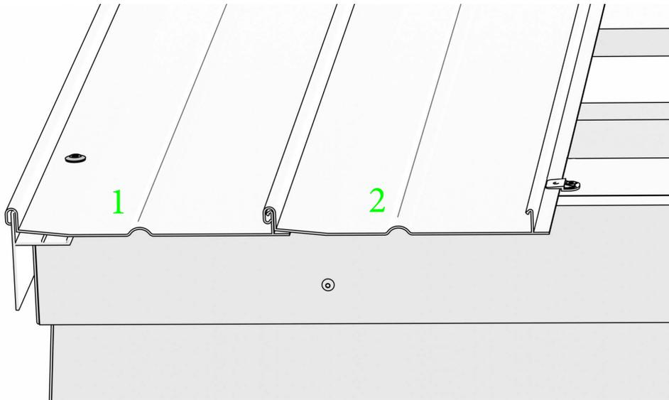
Dachbahn A einclipsen und erneut 4 mal Halteclip D anschrauben. Bei den mittleren Clips die Schrauben ins andere Loch als bei der ersten Bahn schrauben.
