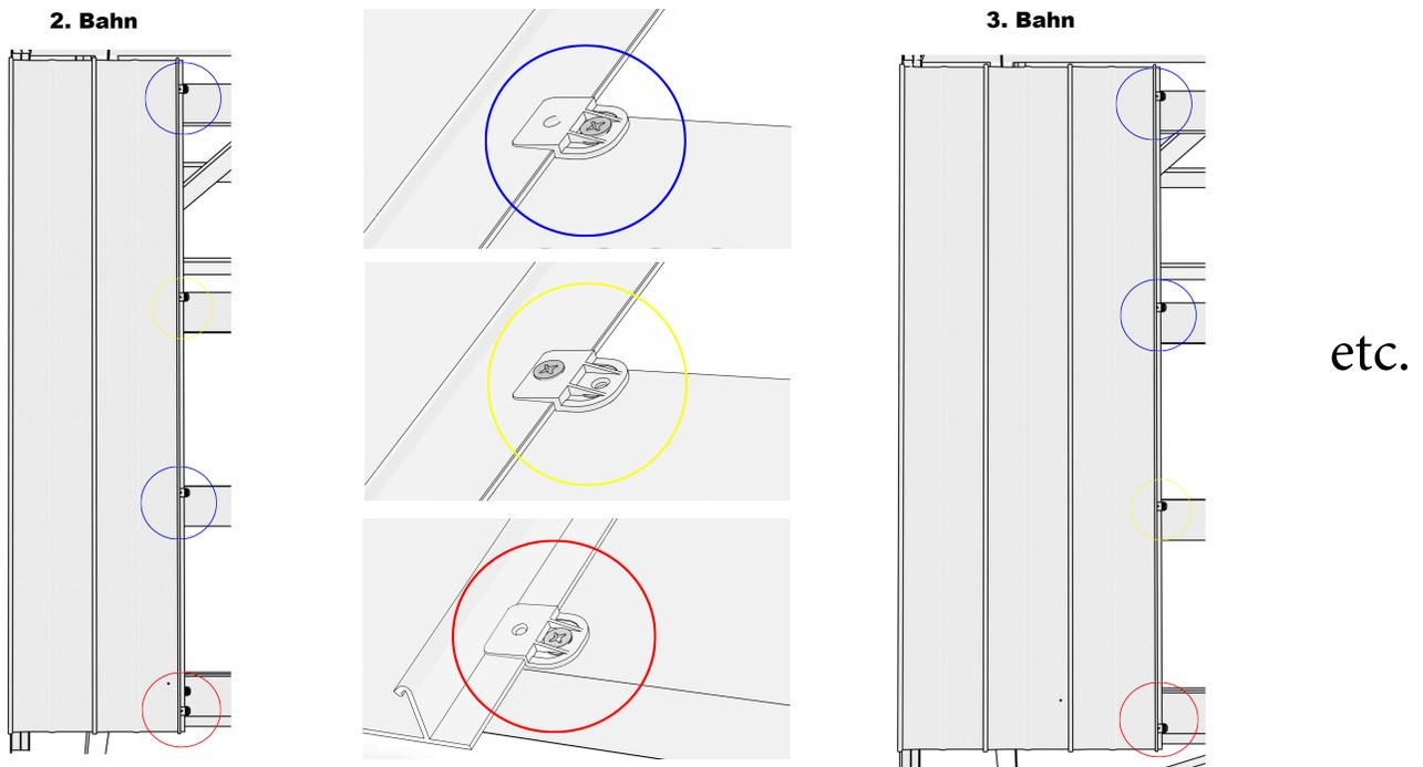
Dies geschieht bei jeder Bahn im Wechsel, sodass jede zweite Bahn gleich verschraubt ist. Diesen Vorgang bis zur vorletzten Bahn wiederholen.
