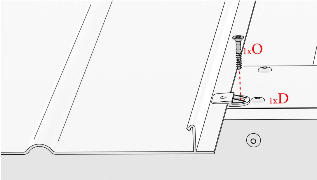
4 mal pro Dachbahn (1 mal mit jedem der vier Konterprofile E-5050) verschrauben. Einen der 4 Clips allerdings durch das linke Loch und das Dachbahnprofil A schrauben.
